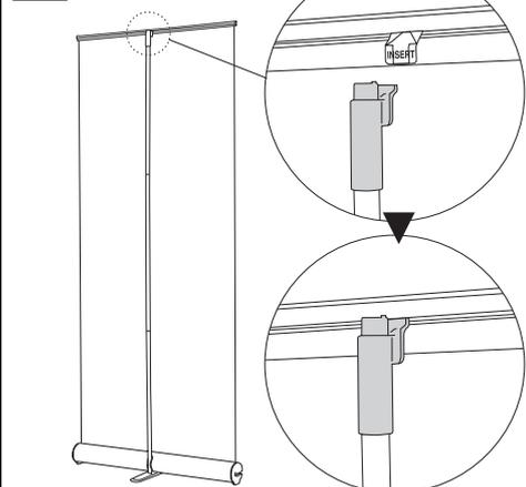
**8** ポールの先端部分が上部バーにしっかりと差し込まれているの確認の上、本体側面についているピンを引き抜いて下さい。
