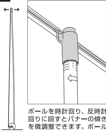
ポールを時計回り、反時計回りに回すとバナーの傾きを微調整できます。ポールを回すと、ポール先端部のメモリ位置が変化します。MAXが見えるとそれ以上は回せません。無理に回さないでください。
